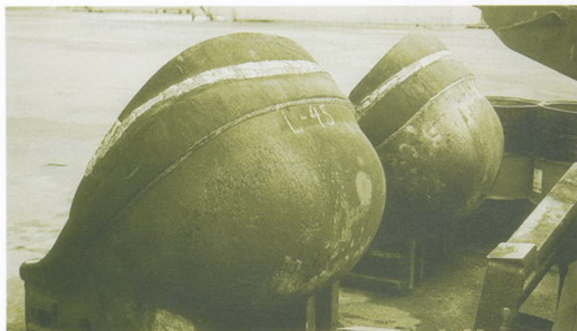
Muchiile noi ale cupelor unui excavator sudate cu electrozi OK 68.82
