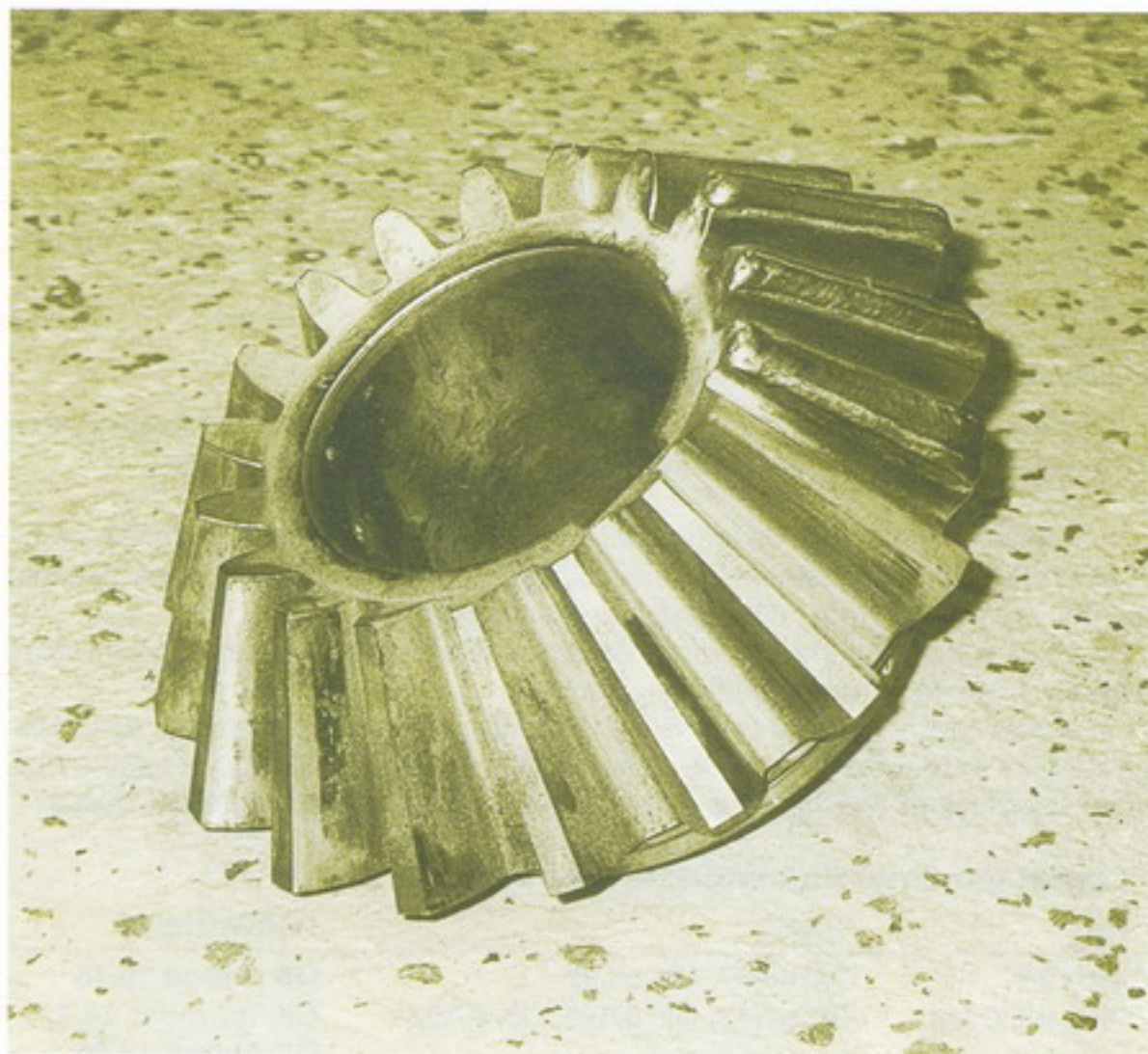
Pinionul dințat. Recondiționare prin încărcare cu electrozi de tip OK 68.82
