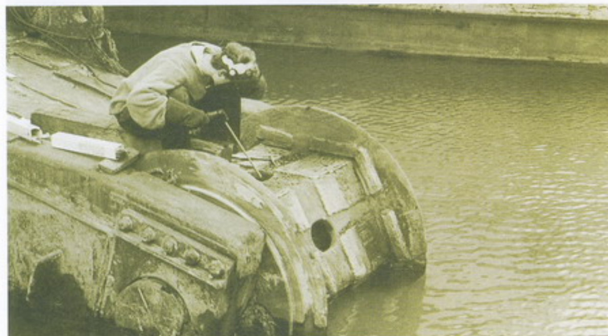
Încărcarea prin sudare a rolei de întindere cu electrodul OK 84.84. Refacerea formei cu ajutorul OK 83.28
