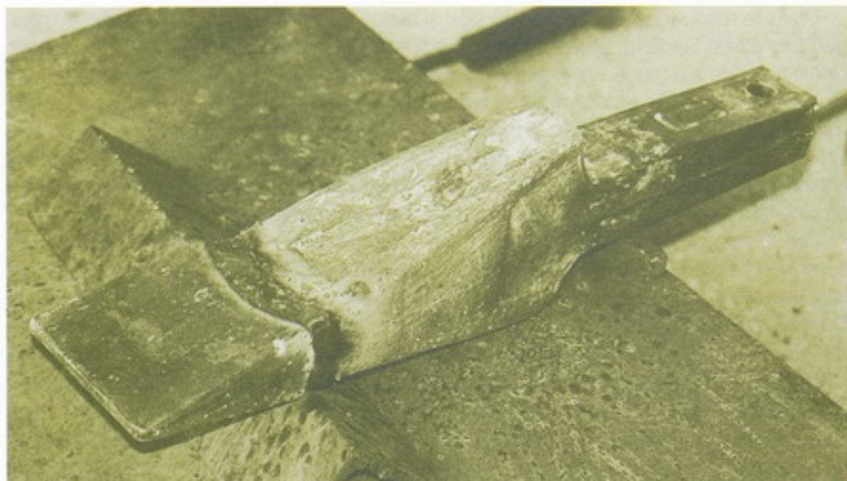
Schimbarea vârfului unui dinte de cupă cu ajutorul OK 67.45 sau OK Tubrodur 14.71
